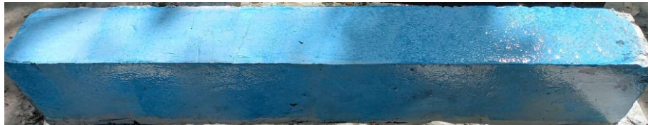
Hình 2.12 Lăn phủ lớp keo epoxy TCK 510R lên bề mặt các dầm
